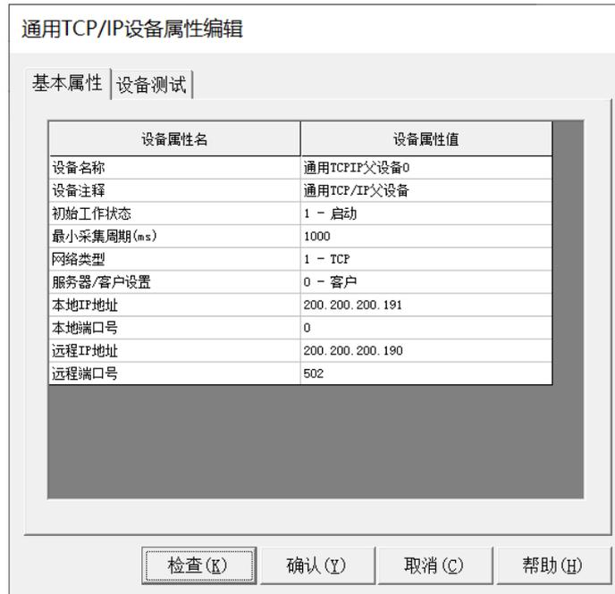
图 15.10-9 设置父设备参数
