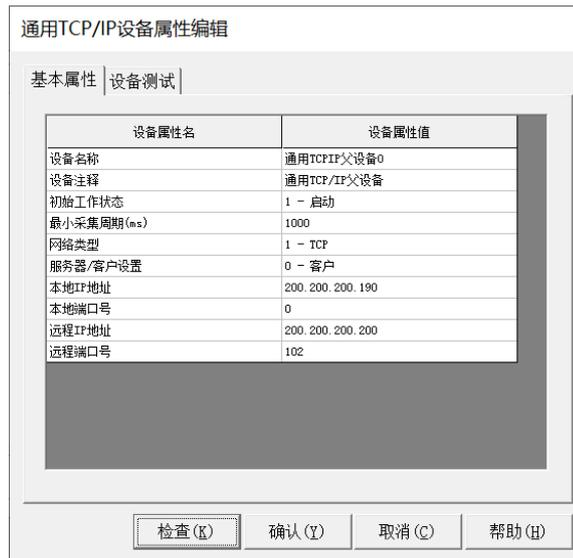
图 15.11-2 设置父设备参数
