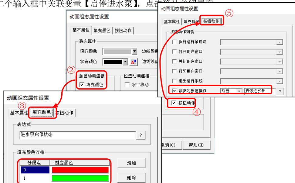
图 3.5-33 设置进水泵填充颜色和按钮动作
