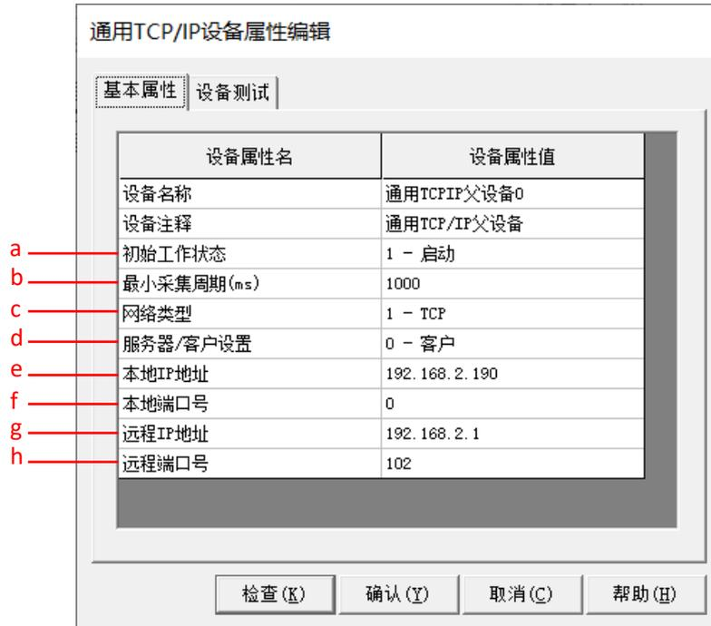
图 15.2-2 通用 TCP/IP 父设备编辑界面
