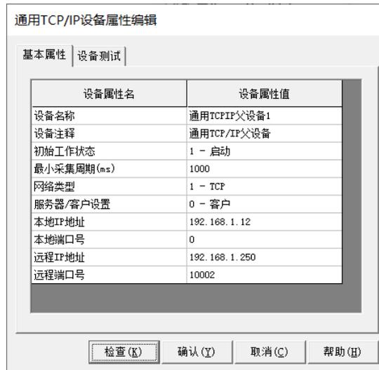
图 15.7-12 按新 PLC 设置新父设备参数
