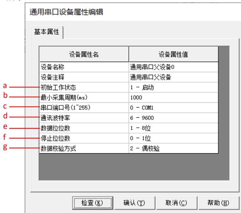
图 15.2-1 通用串口设备属性编辑界面
